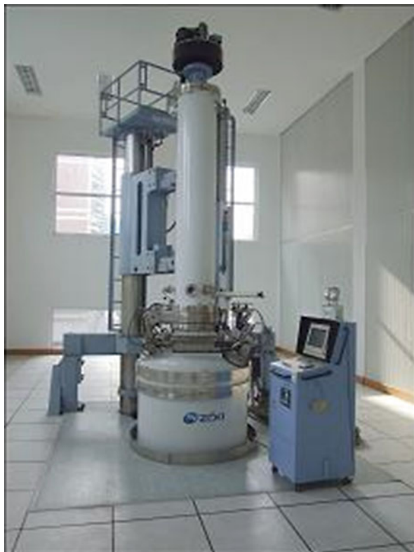
Fig. 1 A CZ silicon crystal puller
