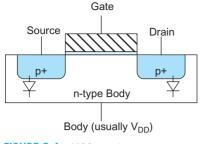
FIGURE 2.4 pMOS transistor
