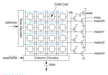
FIGURE 12.70 4 × 4 CAM array
